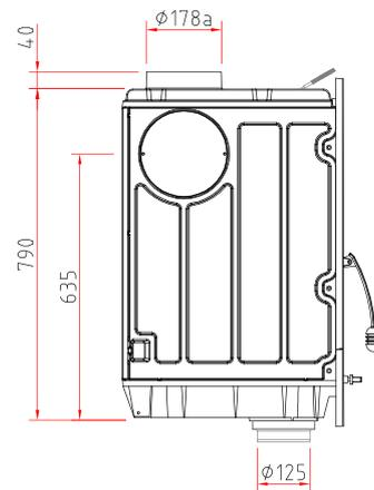
Verbrennungsluftstützen und Feuerraumfühler
