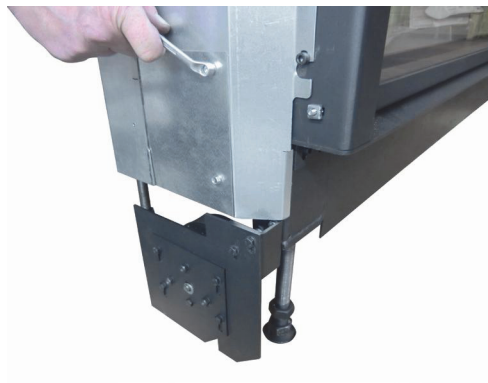
3.10. Справа и слева открепить люки у защитных кожухов подъёмных механизмов 8-гранным ключом
